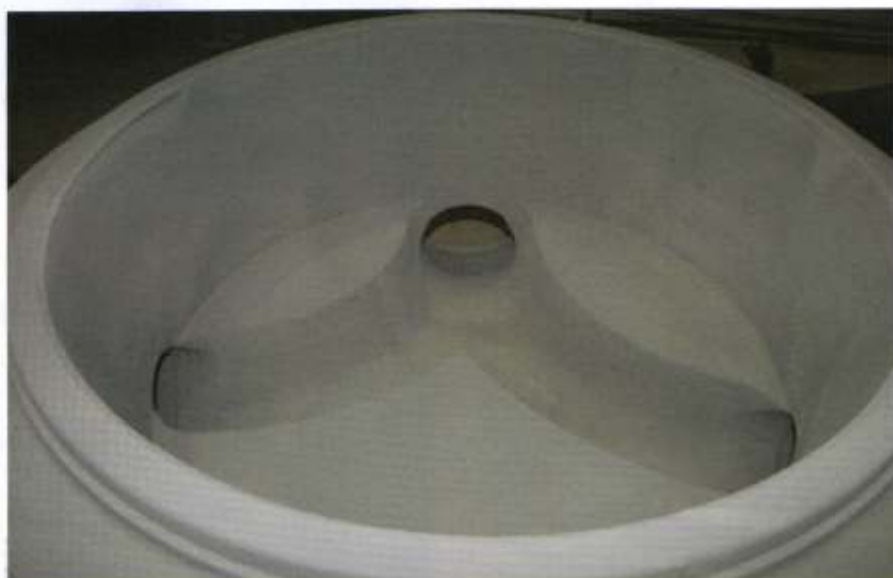
Base de poço de inspeção de concreto finalizada
