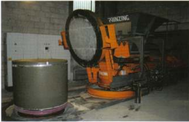
Os monólitos de poços de inspeção de concreto são produzidos pela máquina aprovada da Atlas
