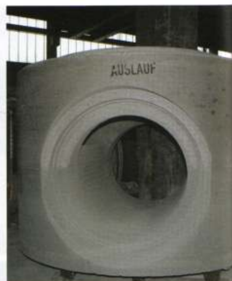
Base fresada de poço de inspeção, NW 1.200 mm, altura total 1.400 mm com conexões fresadas e canais para tubos de concreto FBS, NW 800 mm
