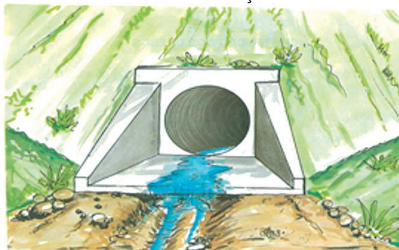
FIGURA 11.17 - Construção de Coletor e Dissipador de Energia
