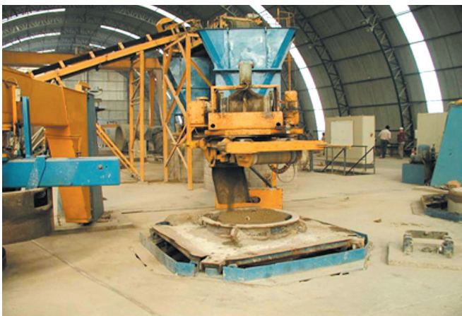
FIGURA 6.3 - Lançamento do concreto para a fabricação dos tubos
