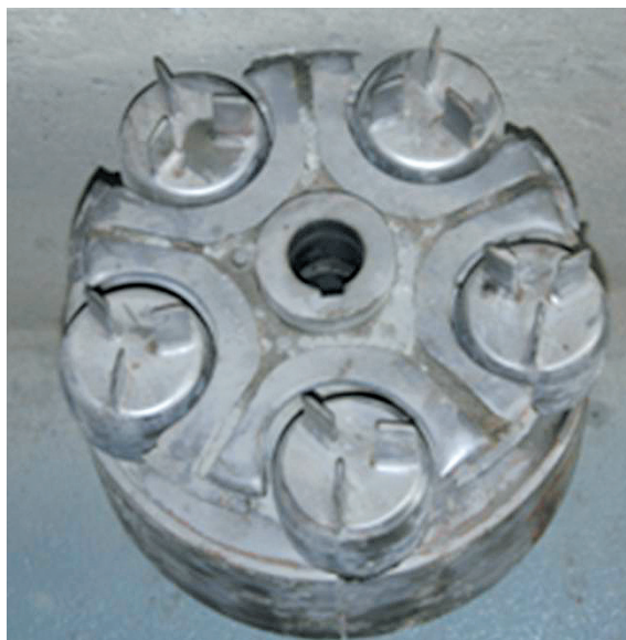
FIGURA 8.3 - Vista frontal do êmbolo e roletes para fabricação de tubos DN 500
