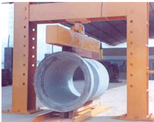
FIGURA 7.4 - Esquema do ensaio para tubo macho e fêmea – NBR 8890
