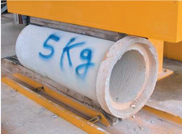
FIGURA 5.62 - Posicionamento de tubo de CRFA com 5kg/m 3 para o ensaio de compressão diametral
