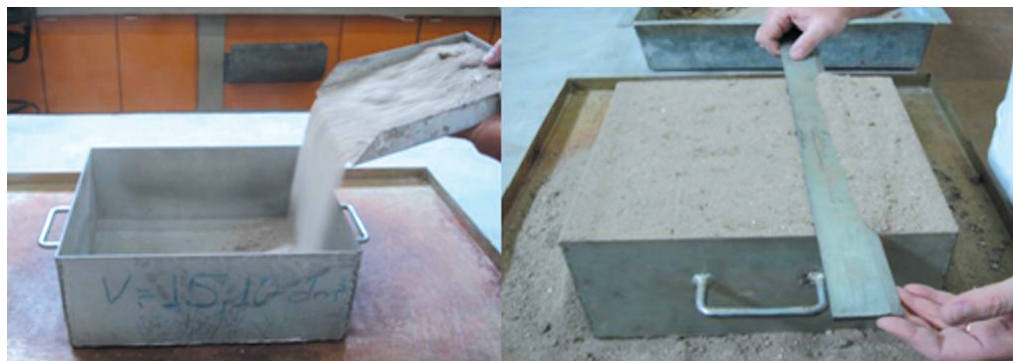
FIGURA 5.4 - Recipiente utilizado na determinação da massa unitária solta de agregado miúdo, NBR NM 52
