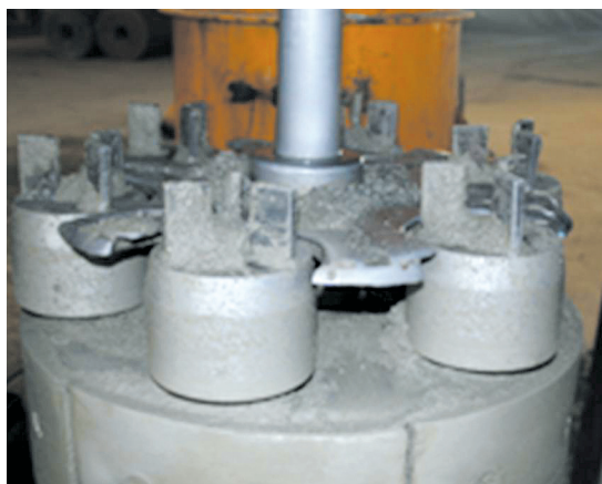
FIGURA 8.1 - Êmbolo simples e roletes para adensamento radial
