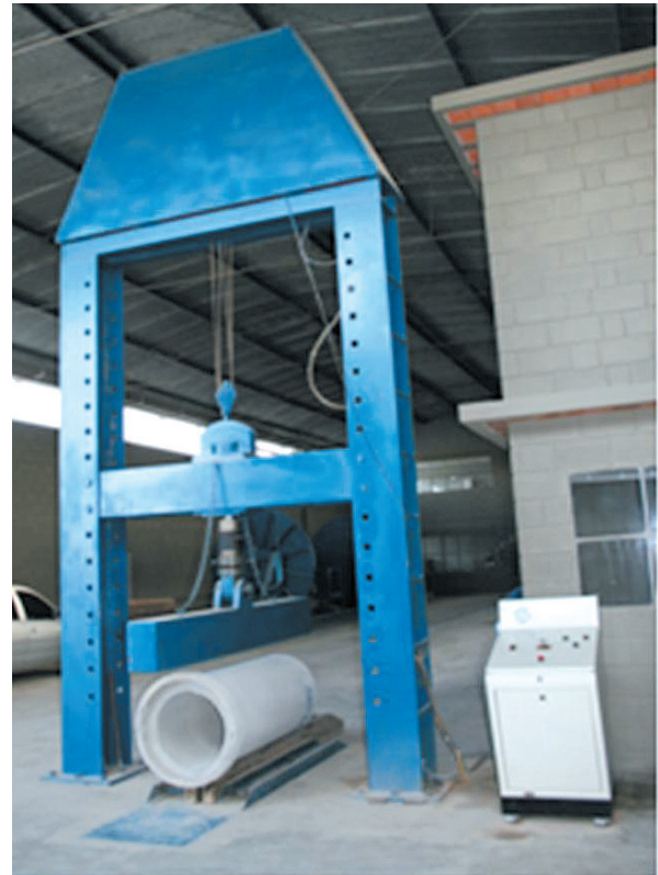
FIGURA 8.6 - Prensa hidráulica para ensaio de compressão diametral em tubos
