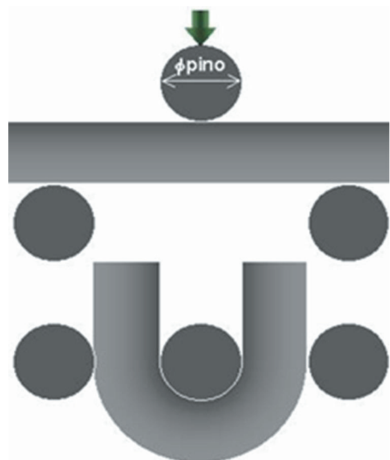
FIGURA 5.27 - Esquema do ensaio de dobramento semiguiado com indicação do diâmetro do pino de dobramento ( \phi pino)
