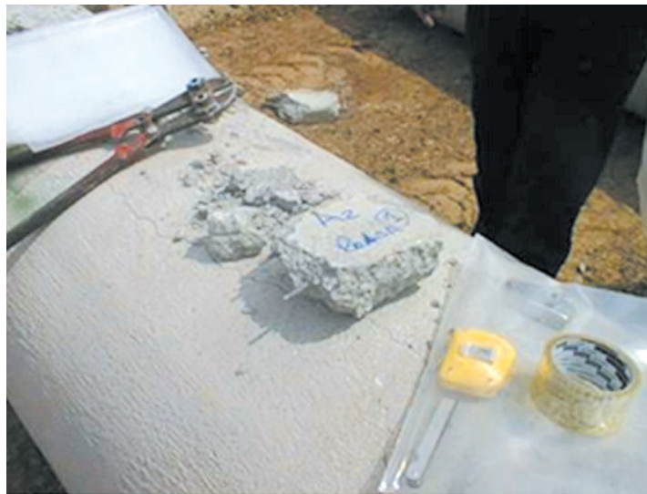
FIGURA 7.9 - Corpo-de-prova retirado de tubo de concreto, após o ensaio de resistência a compressão diametral
