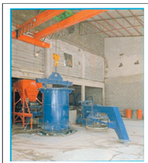
2 - descida do molde externo para acoplamento no molde interno
