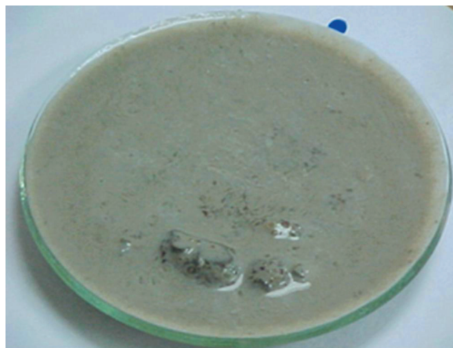
FIGURA 5.16 - Corpo-de-prova de cimento Portland não resistente ao ataque por sulfatos dissolvidos após apenas 35 dias de cura em solução de sulfato de sódio
