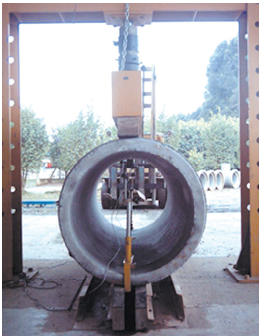
FIGURA 5.47 - Aparato de ensaio de compressão diametral de tubos de concreto para águas pluviais e esgoto
