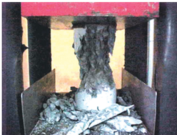
FIGURA 7.17 - Ensaio de resistência à compressão de corpo-de-prova cilíndrico
