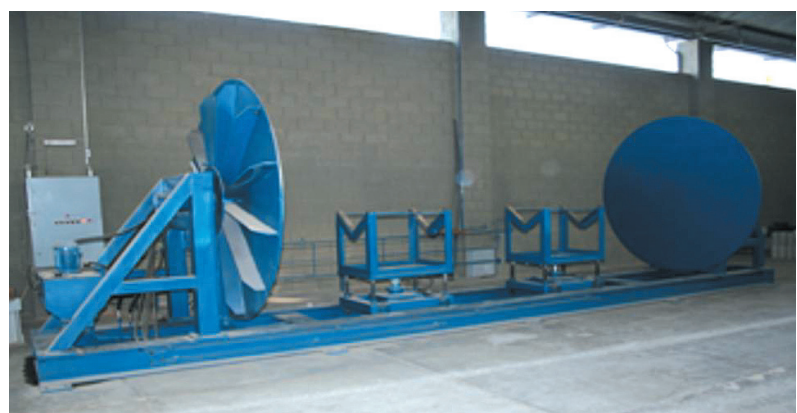
FIGURA 8.7 - Dispositivo para ensaio de estanqueidade de junta e permeabilidade
