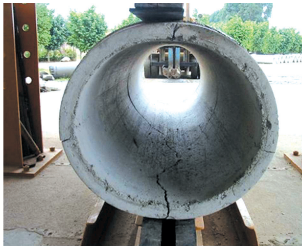
FIGURA 5.52 - Tubo de concreto com fibras sendo submetido ao ensaio de compressão diametral
