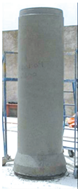
FIGURA 5.61 - Superfície de tubo de concreto com fibras com excelente acabamento sem a presença de fibras na superfície
