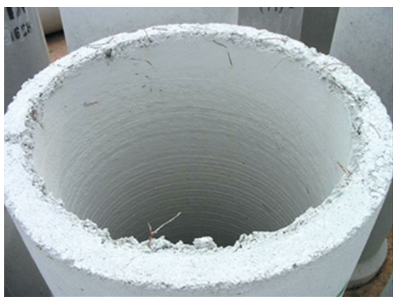
FIGURA 5.59 - Fibras expostas na ponta de um tubo centrifugado
