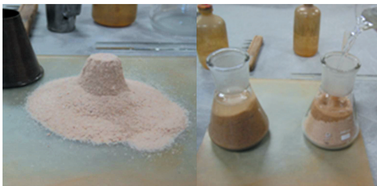
FIGURA 5.3 - Determinação da condição saturada superfície seca (lado esquerdo) utilizada para determinar a massa específica em agregado miúdo por meio do picnômetro, NBR NM 52
