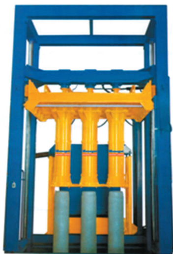
FIGURA 6.8 - Equipamento de vibrocompressão
