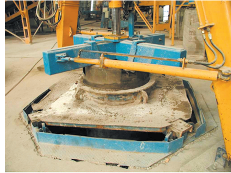
FIGURA 6.5 - Procedimento de compactação na fabricação do tubo
