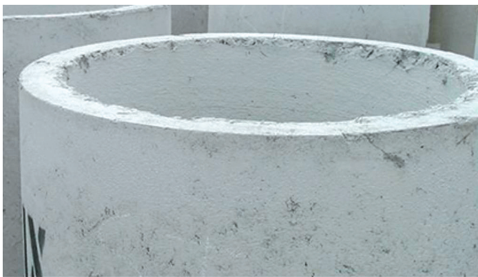
FIGURA 5.60 - Ponta de um tubo feito com concreto com fibras onde se conseguiu um regular embutimento das fibras
