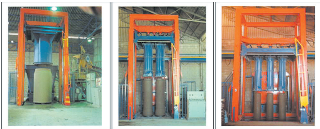
FIGURA 6.6 - Equipamentos de vibrocompressão
