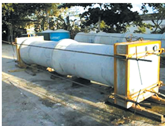
FIGURA 7.10 - Conjunto de ensaio de permeabilidade e estanqueidade em tubos de junta elástica
