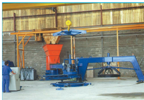
FIGURA 6.7 - Equipamento de vibrocompressão
