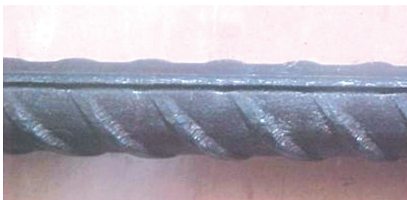
FIGURA 5.17 - Detalhe das mossas em uma barra de aço CA50
