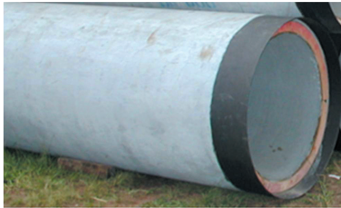
FIGURA 10.2 - Equipamento de produção por processo de vibro-prensagem e tubo utilizado para cravação no processo “jacking pipe”
