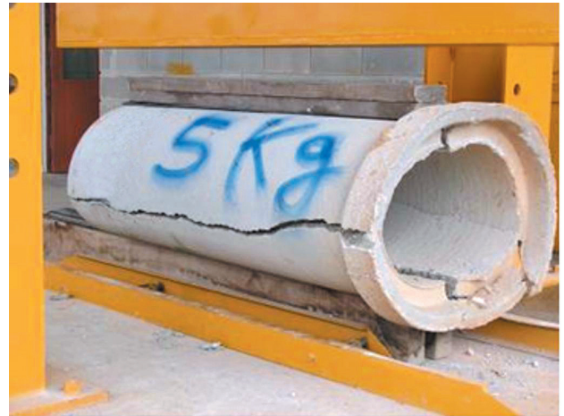
FIGURA 5.63 - Tubo de CRFA com 5kg/m 3 após ter sido submetido a grandes deformações durante o ensaio de compressão diametral
