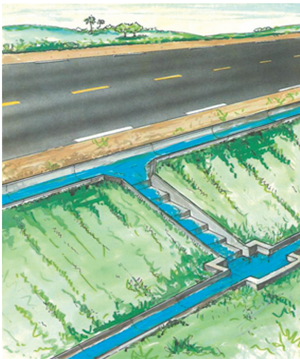
FIGURA 11.22 - Descidas de Água
