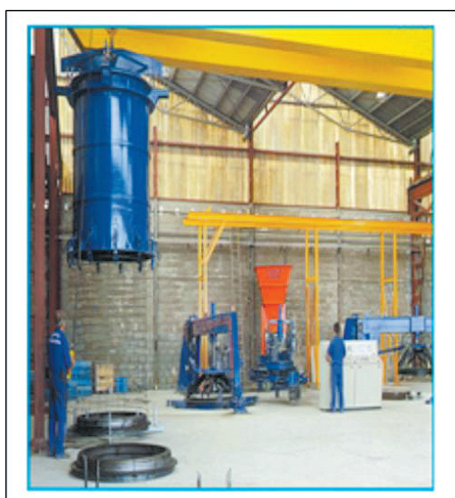
1 - molde externo sendo acoplado na armadura
