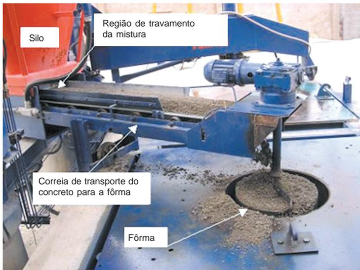
**FIGURA 5.56** - Situação em que houve bloqueio da movimentação da mistura destinada à moldagem de um tubo de concreto devido a adição de elevado teor de fibras sem ajuste do traço da mistura
