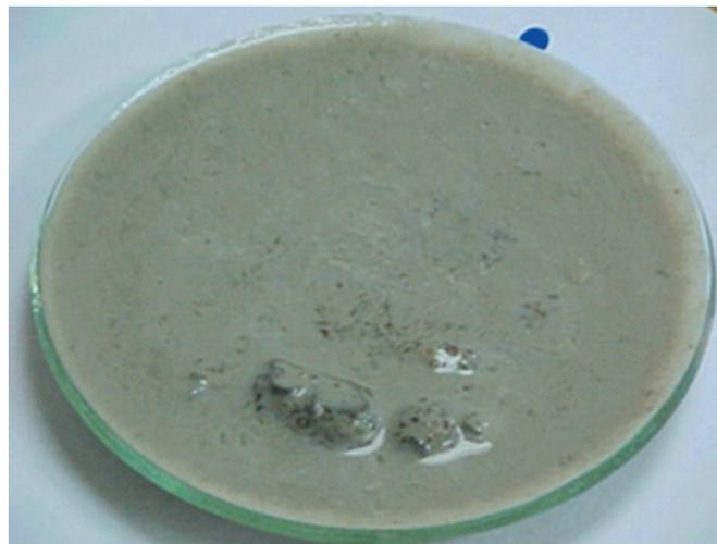
**FIGURA 5.16** - Corpo-de-prova de cimento Portland não resistente ao ataque por sulfatos dissolvidos após apenas 35 dias de cura em solução de sulfato de sódio
