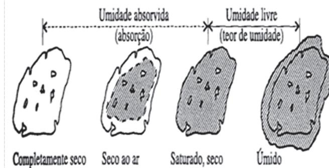
FIGURA 5.2 - Estados de umidade presentes em um grão de agregado (NEVILLE, 1997)
