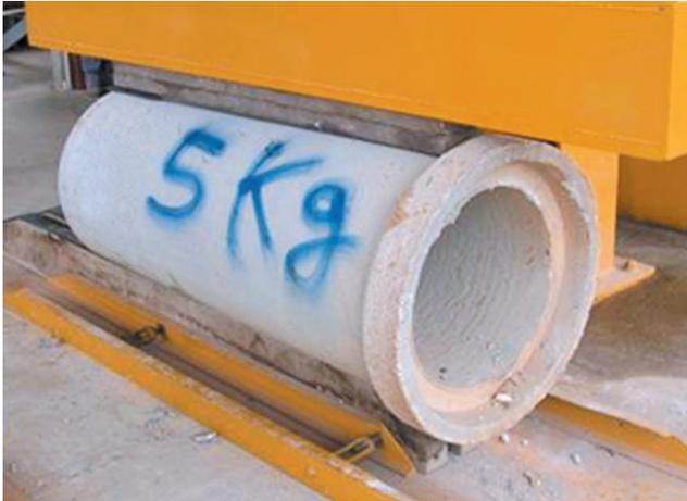
**FIGURA 5.62** - Posicionamento de tubo de CRFA com 5kg/m<sup>3</sup> para o ensaio de compressão diametral
