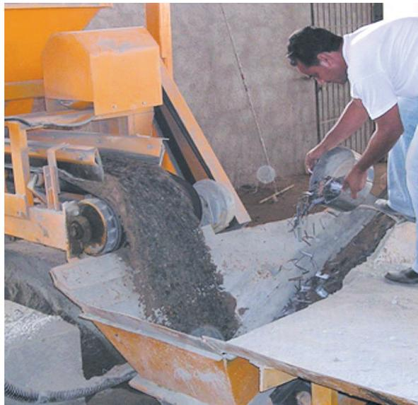
**FIGURA 5.58** - Lançamento de fibras coladas na correia transportadora de agregados para a betoneira
