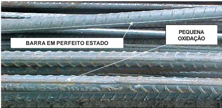
**FIGURA 5.29** - Oxidação leve em barras de aço para concreto armado
