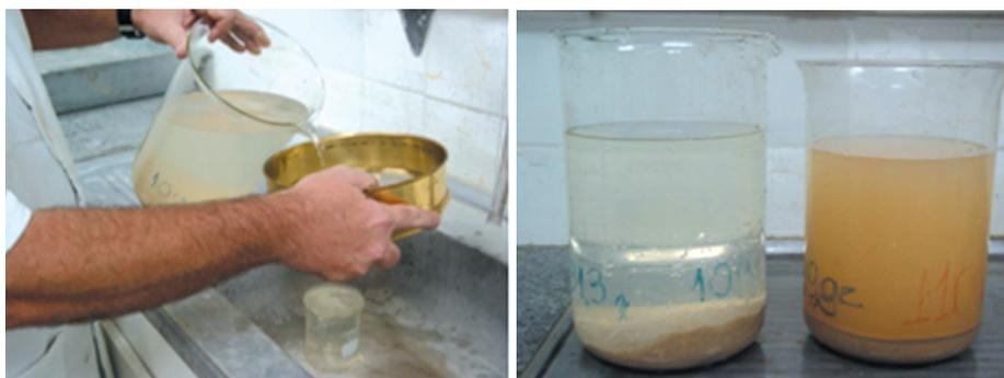
FIGURA 5.7 - Determinação do teor de material pulverulento
