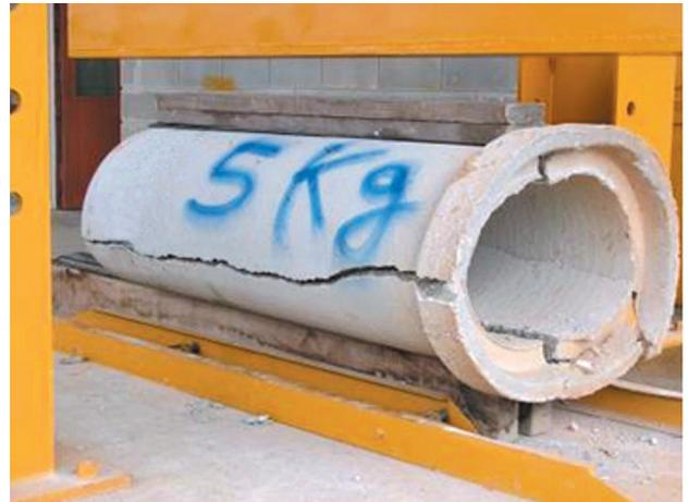
**FIGURA 5.63** - Tubo de CRFA com 5kg/m<sup>3</sup> após ter sido submetido a grandes deformações durante o ensaio de compressão diametral
