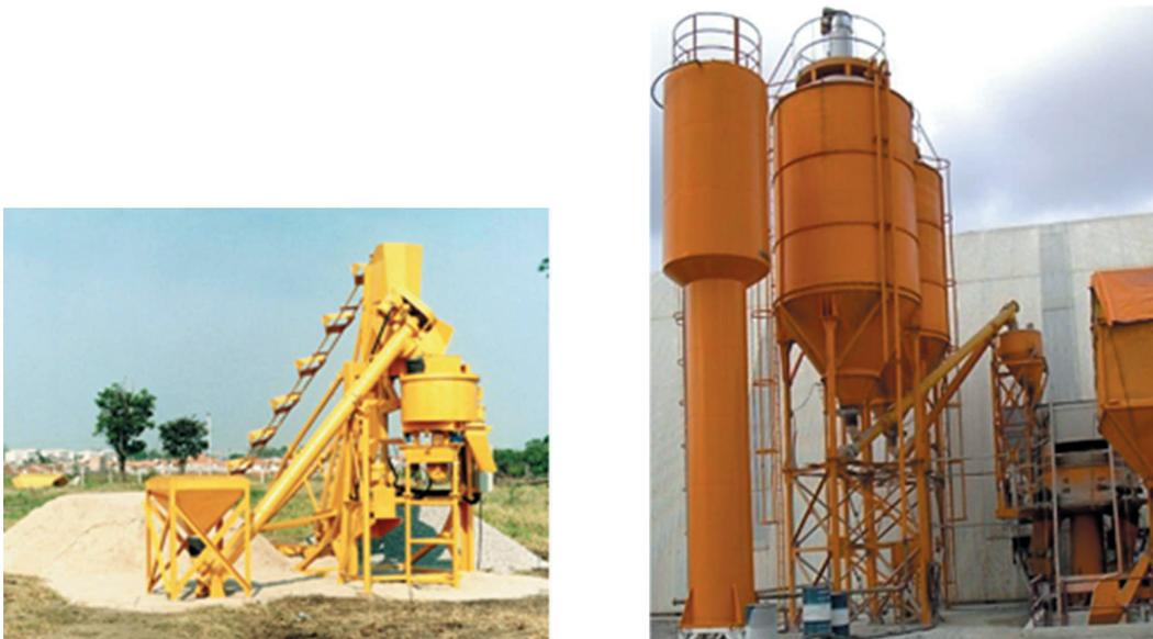
**FIGURA 6.4.3** - Transportador Helicoidal
