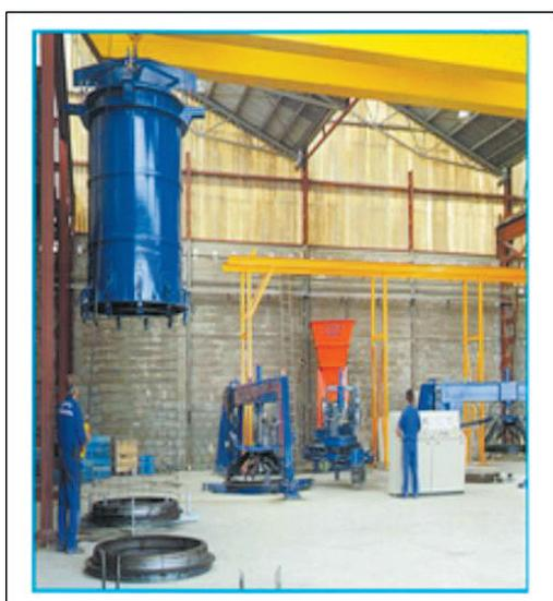
1 - molde externo sendo acoplado na armadura
