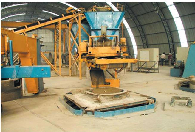
Os equipamentos de vibrocompressão, geralmente instalados em fossos abaixo do nível do piso para reduzir ruídos, se alimentam do concreto geralmente procedente de correias transportadoras, situadas sobre a máquina para enchimento dos moldes, conforme apresentado na figura 6.3.
