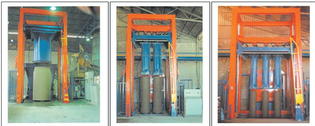
**FIGURA 6.6** - Equipamentos de vibrocompressão
