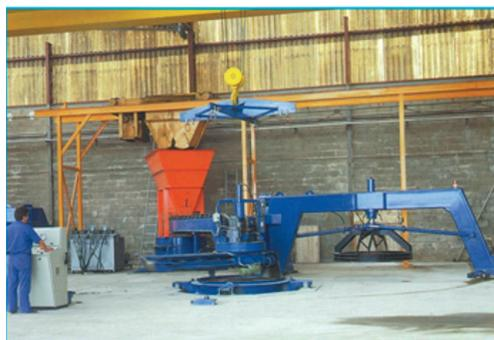
**FIGURA 6.7** - Equipamento de vibrocompressão
