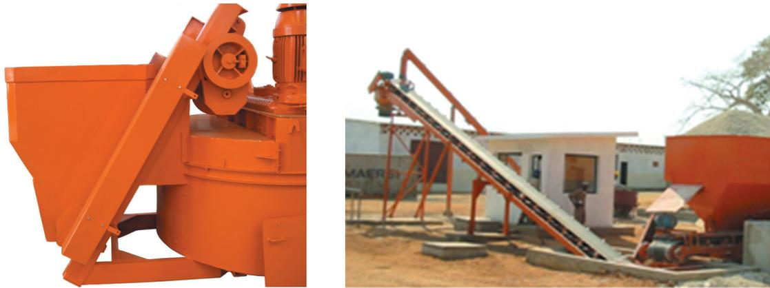
**FIGURA 6.4.5** - Transportadora por skip ou por correia
