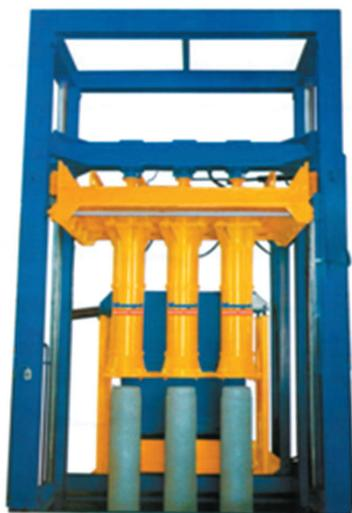
**FIGURA 6.8** - Equipamento de vibrocompressão
