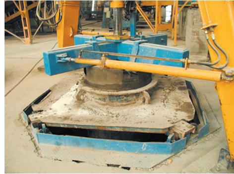
**FIGURA 6.5** - Procedimento de compactação na fabricação do tubo
