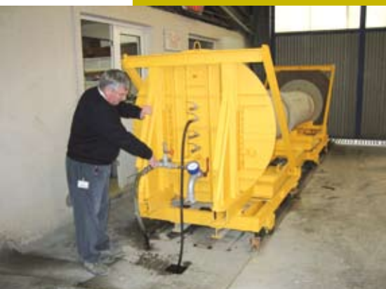
Teste de estanqueidade
